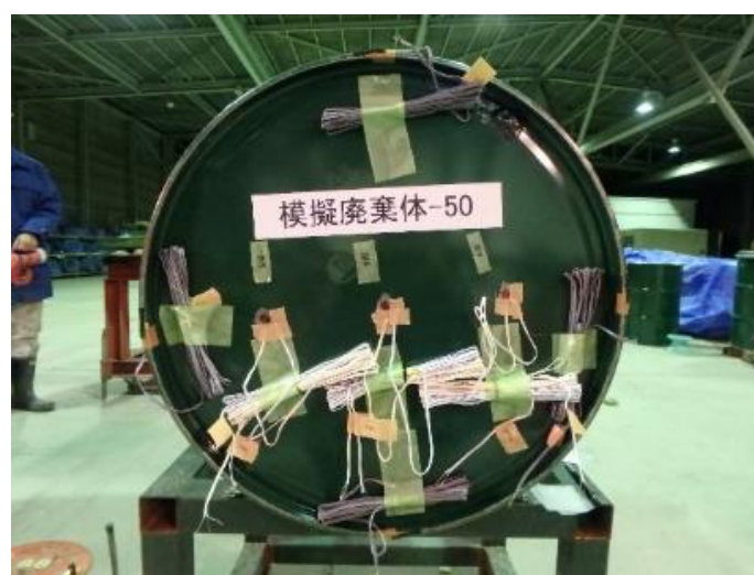
写真 14 試験体蓋部のひずみ計の設置状況 2
