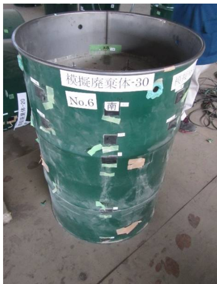
写真 32 載荷終了後の状態 (試験体 30)
