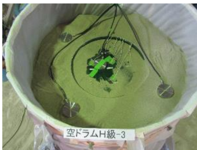
写真 26 土圧計の設置状況 2
