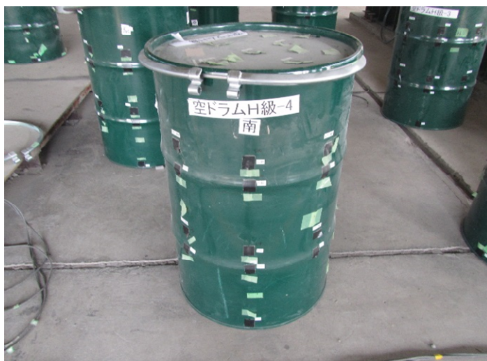
写真 29 載荷終了後の状態 (200 リットルドラム缶 H 級-4)
