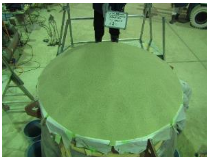
写真 27 地盤材料の投入完了時の状況
