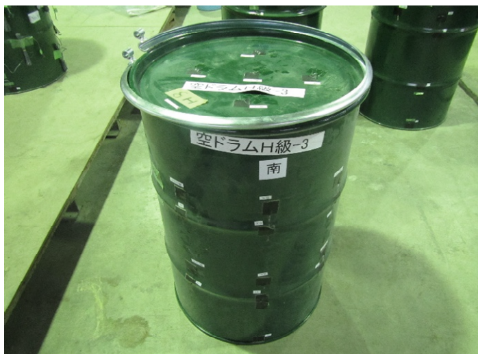
写真 28 載荷終了後の状態 (200 リットルドラム缶 H 級-3)
