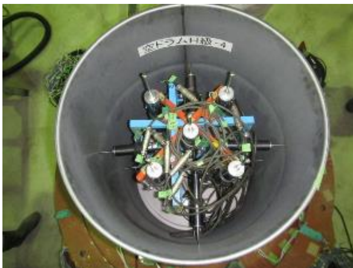
写真 18 200 リットルドラム缶内の変位計の設置状況
