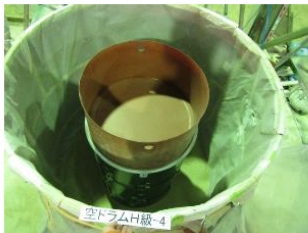
写真 24 鋼製円筒殻容器内にドラム缶を設置した状況
