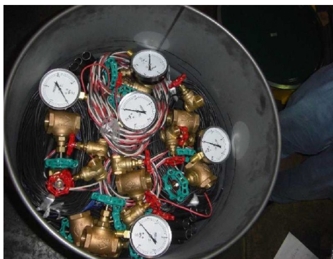
写真2 ドラム缶に模擬廃棄物を収納した状況 2
