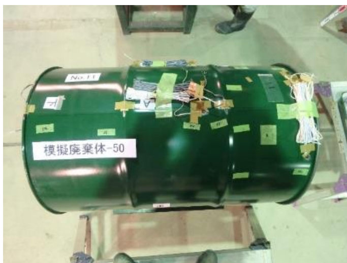
写真 11 試験体側部のひずみ計の設置状況
