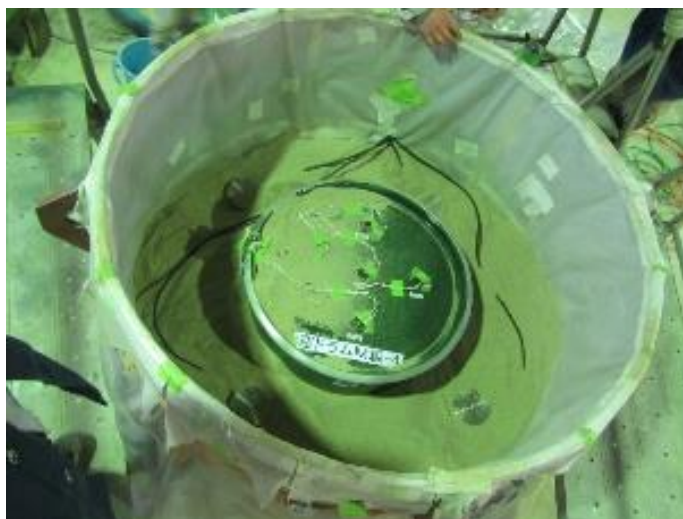
写真 25 土圧計の設置状況 1
