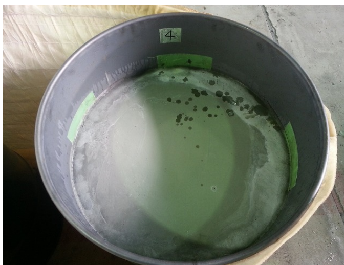
写真 6 P ロート流下時間 30 秒のモルタルを充填した試験体の硬化後の状況
