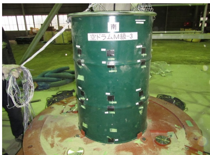
写真 30 載荷終了後の状態 (200 リットルドラム缶 M 級-3)
