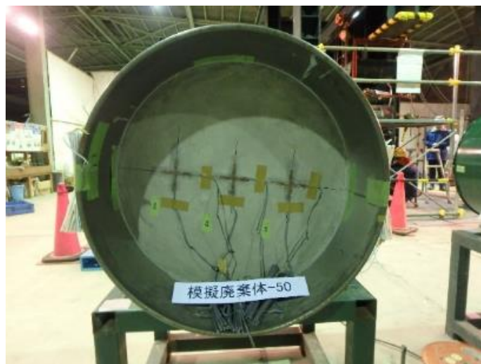
写真 12 固型化部頂面のひずみ計の設置状況
