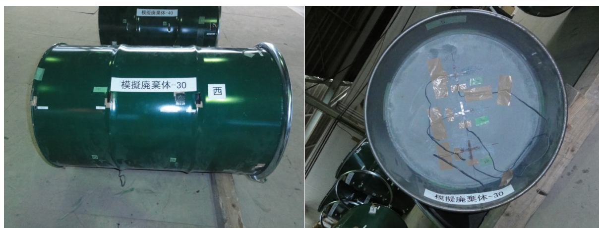
写真 15 載荷終了後の状態 (試験体 30)
