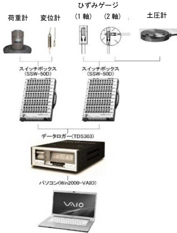
図 4-5 トレンチに係る計測システム
