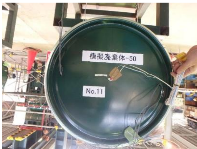
写真 13 試験体蓋部のひずみ計の設置状況 1
