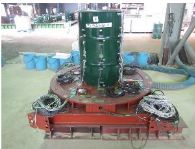
写真 20 固定アーム（底板）への試験体の設置
