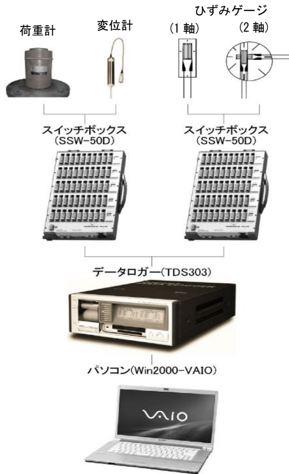
図 3-2 ピットに係る計測システム
