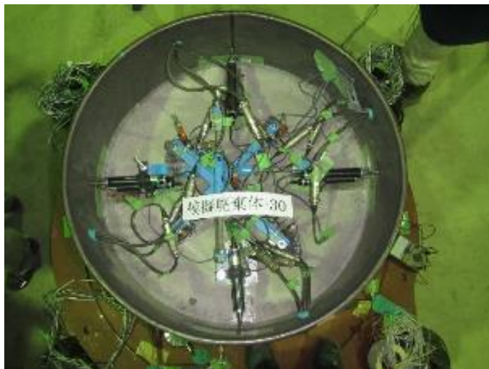
写真 19 試験体 30 の変位計の設置状況
